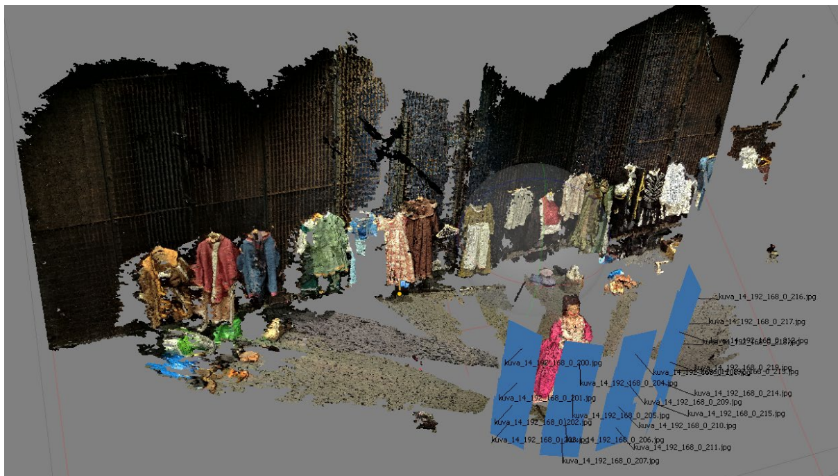
Kuva 3. Kuvakaappaus Raspberry Pi -kamerajärjestelmän kuvista tuotetusta pistepilvestä. Oikealla alhaalla näkyvät 3D-mallin laskemiseen käytettyjen kameroiden sijainnit. © Aalto Memo
