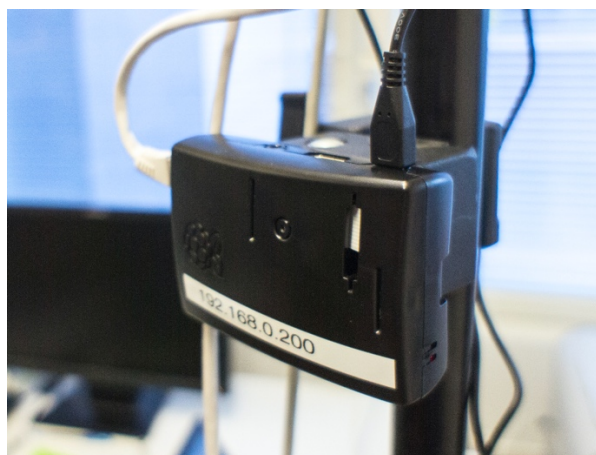
Kuva 2. Raspberry Pi ja kamera koteloituna ja yhdistettynä paikalliseen lankaverkkoon. © Aalto Memo
