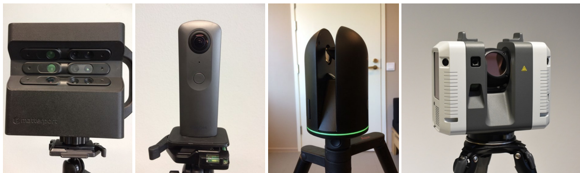
Kuva 1. Laitevertailuun käytetyt laitteet. Ylärivissä vasemmalta Matterport Pro2 3D, Ricoh Theta V, Leica BLK360 ja Leica RTC360.
