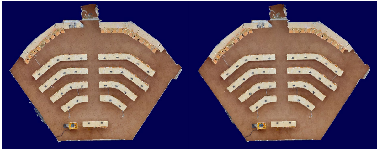
Kuva 8. Theta V-pistepilvi (vasemmalla) ja Theta V-kolmiomalli (oikealla) Tetra-salista.
