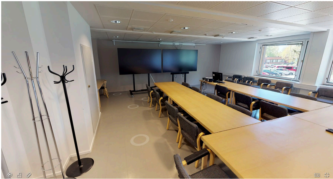
Kuva 10. Näkymä Matterportin selainpohjaisesta esityksestä; lattiassa näkyvät ympyrät näyttävät panoraamakuvien paikan, ja kyseiseltä pisteeltä otettua panoraamakuvaa voi tarkastella valitsemalla ympyrän.
