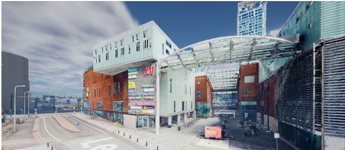
Kuva 2. Laserkeilauksen ja fotogrammetrian yhdistämisellä luotu yksityiskohtainen mittatarkka 3D-malli Kalasatamasta. © Aalto Memo
